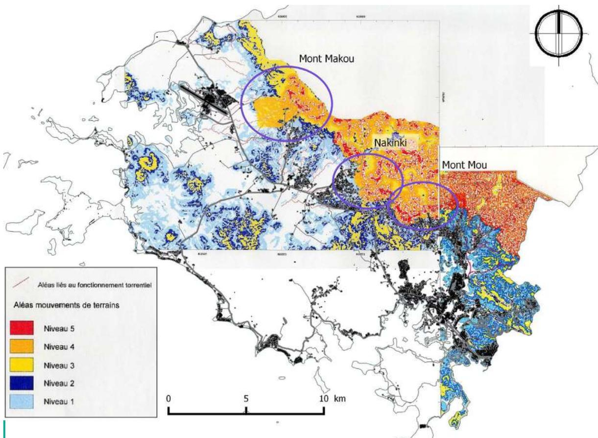
Figure 54 : Cartographie des aléas de mouvements de terrains
